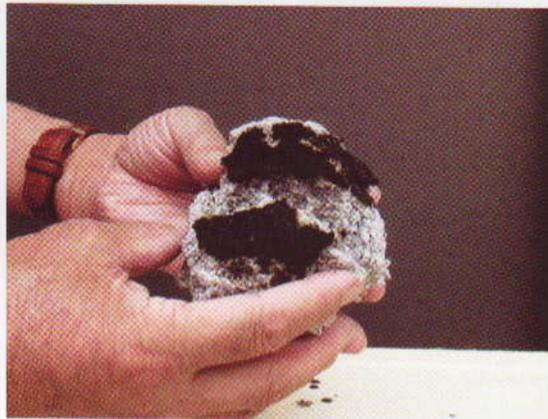
新聞紙が燃えない? いくら火をつけても黒く炭化するだけ。CFの面白さは第一に燃えないこと。そして断熱、調湿、防音、防虫、防錆、安全など住宅性能の全てを完備した断熱材は他のいかなる建材にもない。無暖房の住まいが簡単に実現できるのは、機器による吹き込みにより均等な断熱を得るからだ(右の写真)。世の中は矛盾に満ちているものですが、例えば、アパートの界壁に防火のためCFを吹き込む。NO! と言うのが旧建設省以来の官吏である。新聞紙は燃えるモノという概念が、学者・役人・建築屋の頭を支配している。
